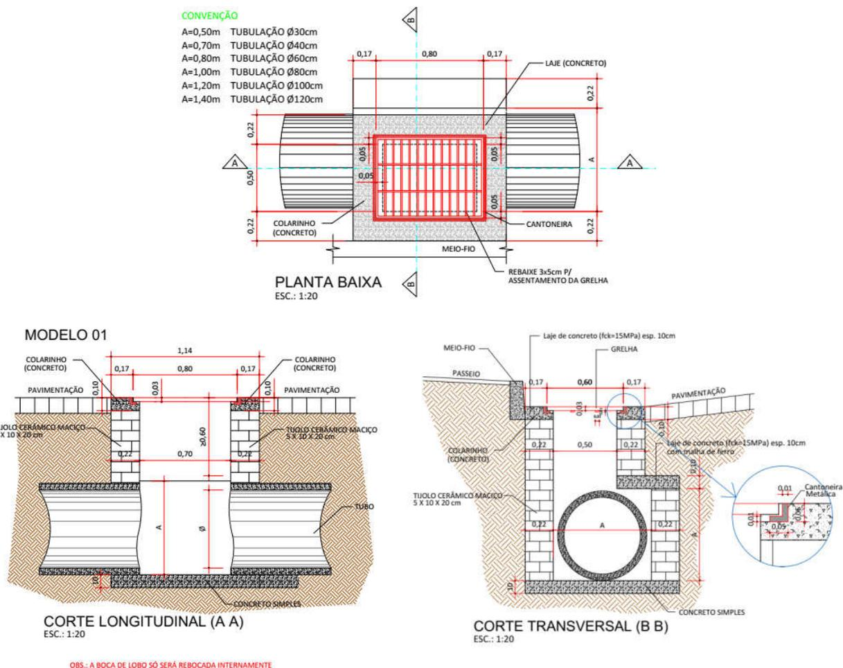
As paredes serão de alvenaria de tijolo maciço, com espessura 22 centímetros, assentadas e rebocadas com argamassa de cimento, cal hidratada e areia média traço 1:2:8 respectivamente, a caixa coletora será somente rebocada internamente.
